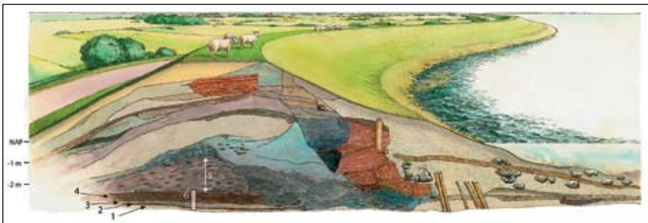
Afbeelding 1: Doorsnede van de Westfrie Omringdijk bij Enkhuizen met diverse ophogingslagen. (1) Ondergrond van zandige klei. (2) Houtskoolrijke laagje dat aan het oppervlak lag tijdens de Bronstijd. (3) Afzetting gevormd in ondiep zoet water. (4) Veenlaag. (5) De oudste, 13 e eeuwse dijk. (6) Voor onderzoek bemonsterde lagen. (Naar Van Geel et al. , 1983; tekening Bob Brobbel).
